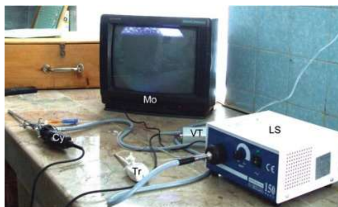
شکل ۳-۴ - دستگاه لاپاراسکوپی برای تعیین جنسیت ماهی ماش، Mo: نمایشگر، Tr: تروکار، LS: منبع نور، VT: انتقال دهنده، Cy: سیستم اسکوپ. (Falahatkar and Tolouei Gilani, 2013).
