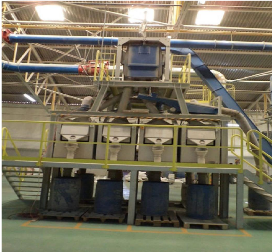
شکل ۴-۱۷: غربال لرزشی با جداکننده الکترواستاتیک و مکانیسم جمع‌آوری در یک واحد فرایندی WEEE
