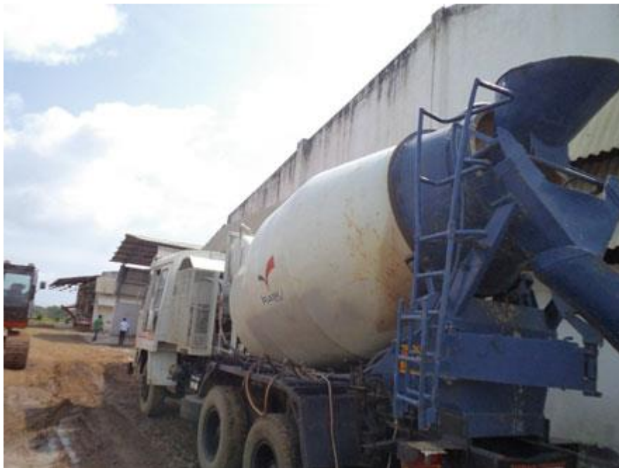
شکل ۷-۱۱ ماشین مخلوط کننده نصب شده در مرکز TSDF برای مخلوط کردن مواد تثبیت کننده.
