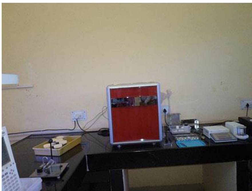
شکل ۲-۸: آنالیزور CHNS که برای تعیین درصد کربن، هیدروژن، نیتروژن و سولفور استفاده می شود.
