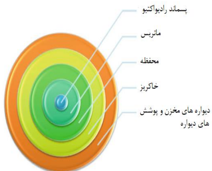
شکل ۷-۱۰ نمودار شماتیک موانع پایه در یک مخزن پسماند هسته‌ای
