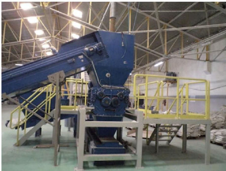
شکل ۴-۲۵: خردکن سرعت پایین با گشتاور بالا
