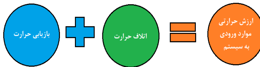
شکل ۵-۱۸ موازنه حرارتی در یک زباله‌سوز
