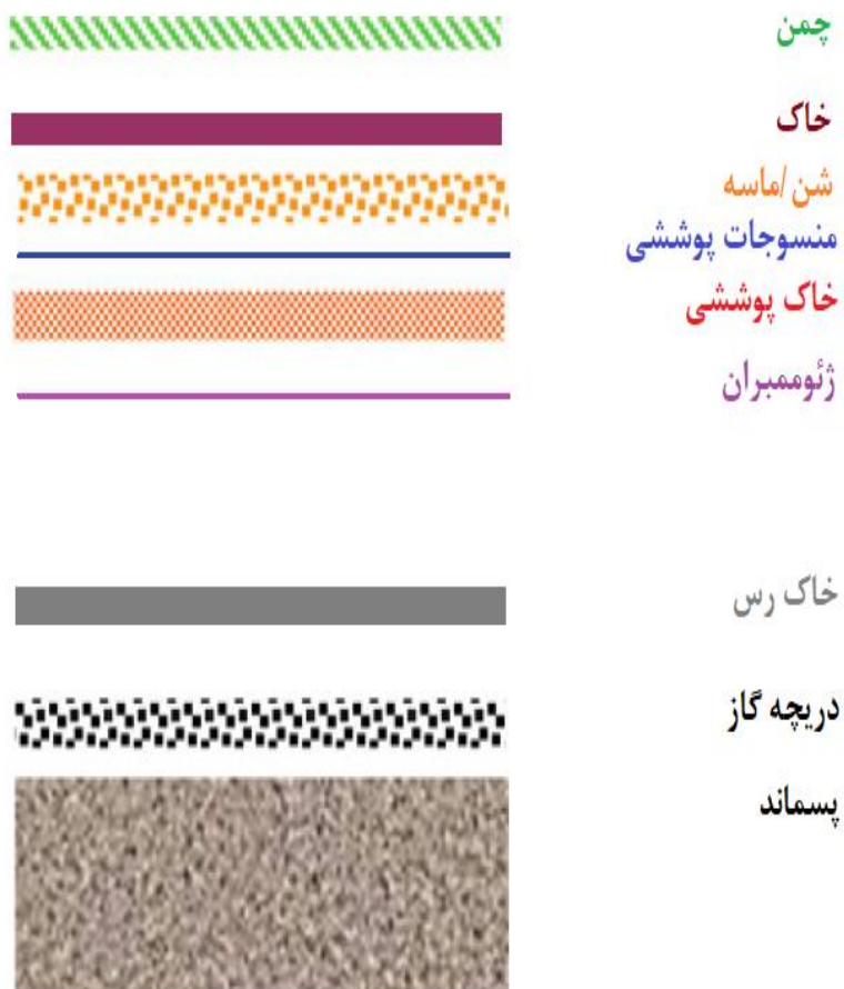
شکل ۵-۸ نمونه‌ای از لایه‌های مختلف در سرپوش لندفیل
