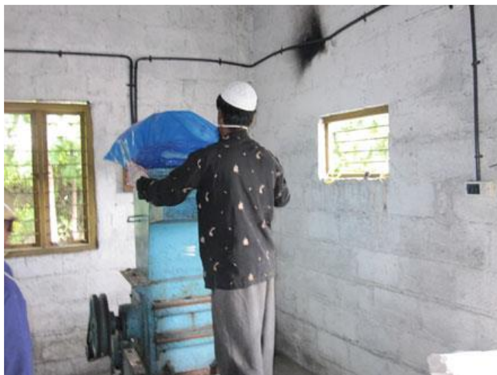
شکل ۶-۱۴ پسماند زیست پزشکی که در حال خوراک‌دهی به خردکننده است.
