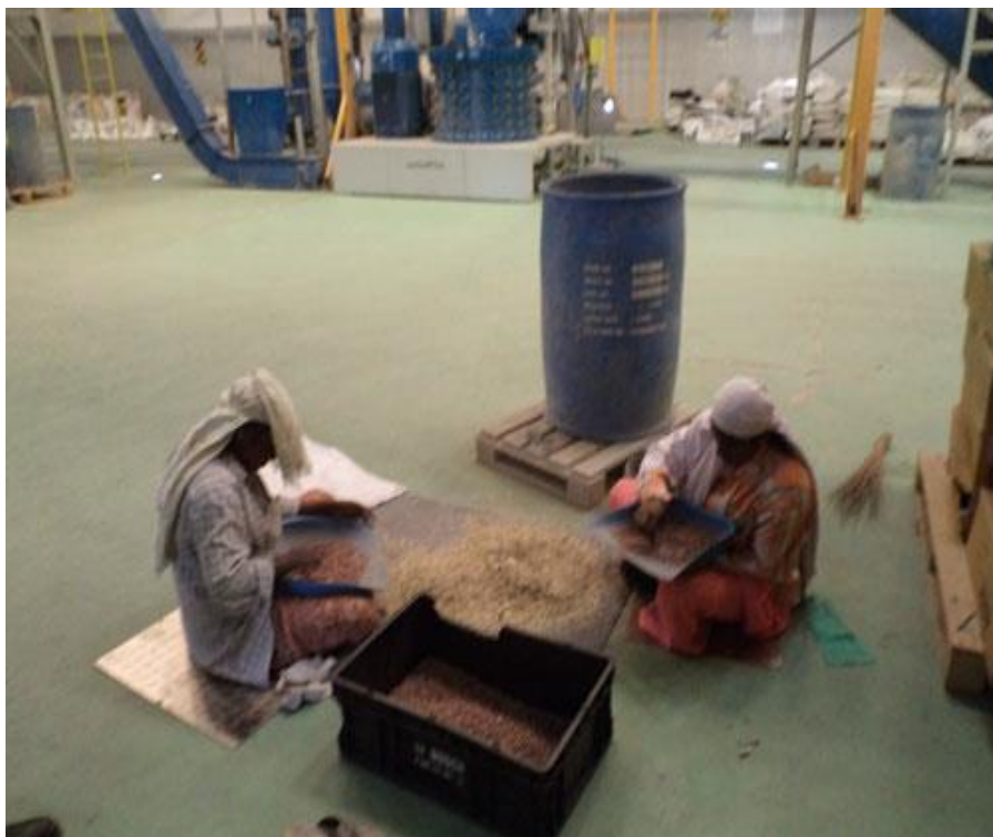
شکل ۸-۱۱ جداسازی دستی کسر بیشتری از گلوله‌های مسی و پلاستیک پس از خرد و غربال کردن
