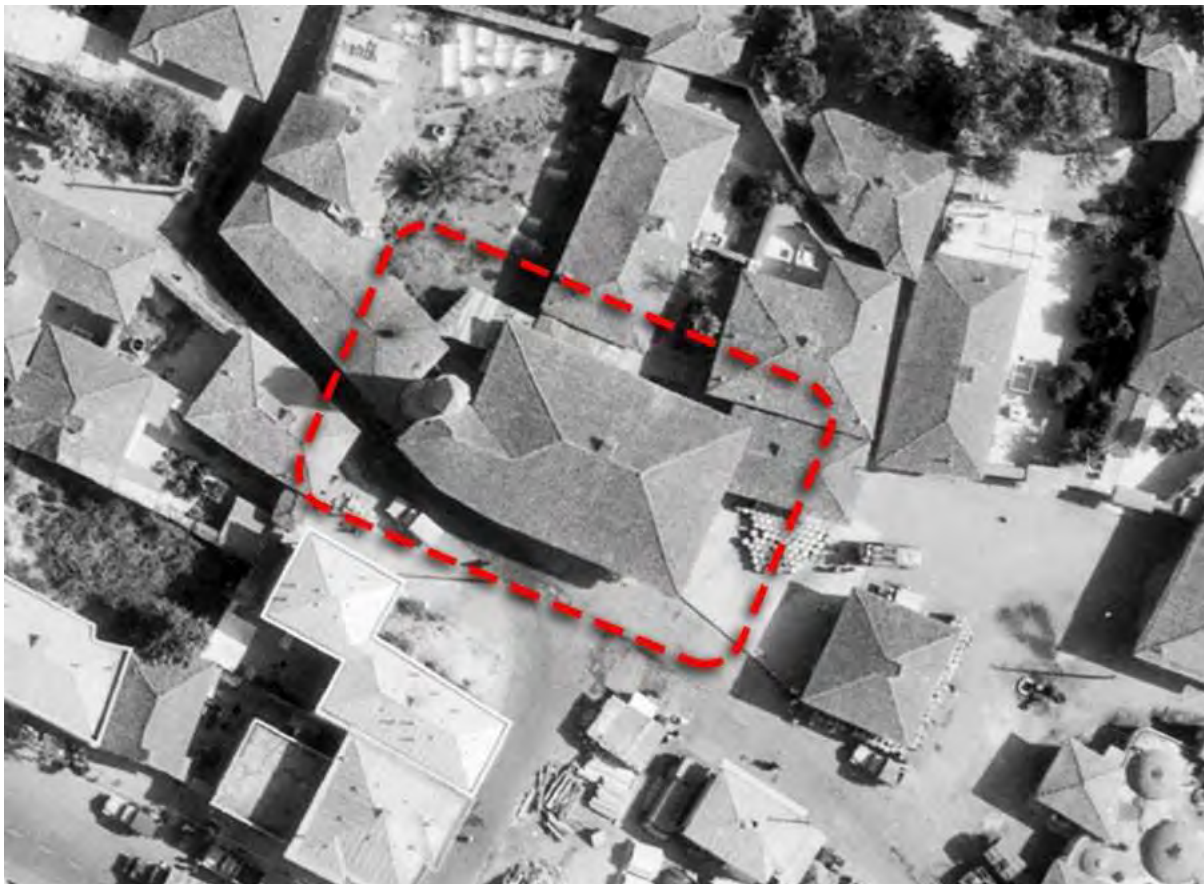
شکل ۱۸۹. در مسجد محله شهربافان نمای اصلی ساختمان رو به سمت شرق و جنوب بوده است، در حالی که لوجنک بام آن به سمت شمال ساخته شده بود.
